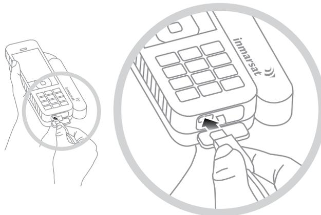
Schließen Sie das Ladegerät an eine Stromquelle und den Micro-USB-Stecker an den Port unter der Schutzabdeckung für USB-/Audioanschluss unten am Telefon an.
