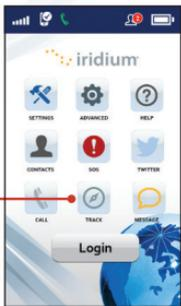
1. Um Quick GPS einzurichten: Gehen Sie zum Menü Iridium GO! App-Einrichtungen, wählen Sie Track und geben Sie dann Quick GPS-Empfänger ein.
